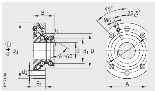
DKLFA..-2RS ( $d \geq 25 \text{ mm}$ )
